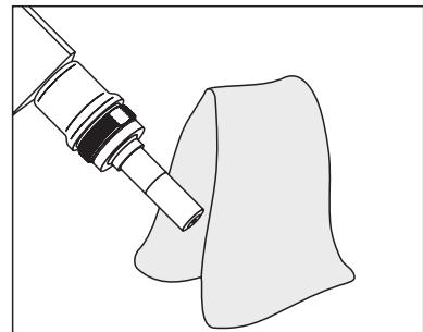
Essuyer la contre électrode avec précaution et la sécher avec un essuie-tout en papier.
