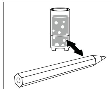
Eliminer les bulles d'air éventuelles par de légers frappements. Il est également possible d'empêcher la formation de bulles d'air en jetant le premier remplissage et en remplaçant à nouveau.
