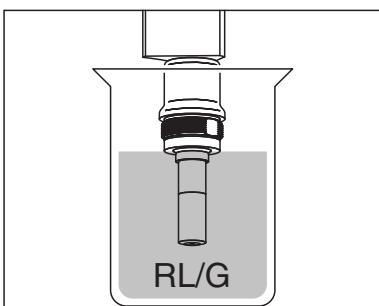
Immerger la tête de sonde, contre électrode comprise, dans la solution de nettoyage RL/G. Laisser agir 1 à 3 minutes.
