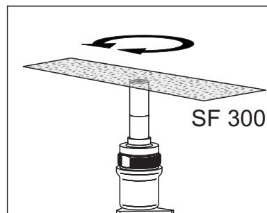
Frotter en appuyant doucement avec la face rugueuse de la feuille abrasive SF 300 **mouillée** pour enlever les souillures de l'électrode de travail or.
