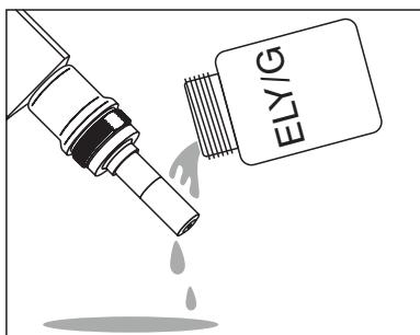
Rincer soigneusement la tête de sonde avec de la solution d'électrolyte.
